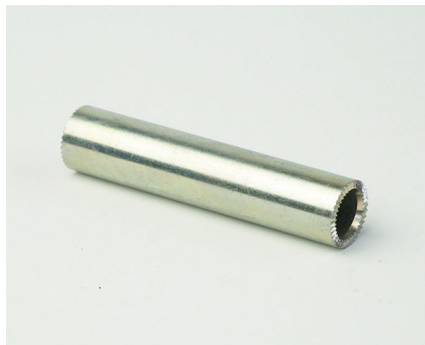
■ インナーパイプ(両鰐セレーション品) 引抜パイプを切断・セレーション加工をし、 浸炭焼入・クロームメッキをした製品です。
