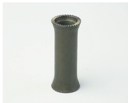
■ インナーパイプ(両鰐拡管セレー ション焼入品) ストレートのパイプをプレス加工し、両端 部を拡管した製品です。又、引抜パイプの ままでは座屈強度が不足する時、浸炭焼入 れをすることにより強度を上げています。
