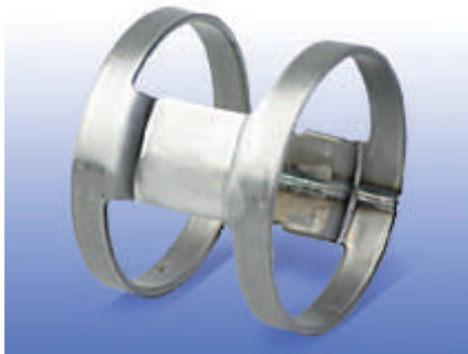
レーザー溶接パイプ 平板を加工後ロール成形し、レーザー溶接し、中心部を絞った製品です。(特許取得済)
