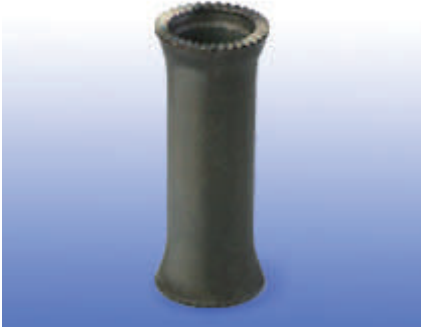
インナーパイプ(両端絞りセレーション) ストレートのパイプをプレス加工し、両端部を拡管した製品です。又、引抜パイプのままでは座屈強度が不足する時、浸炭焼入れをすることにより強度を上げています。
