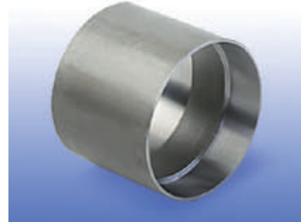
アウターパイプ(内径切削品) パイプを切断・外径・内径・面取り加工後、内径に切削加工を施した製品です。
