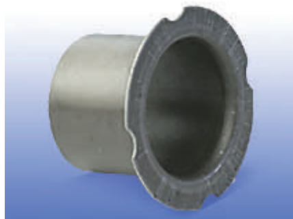
アウターパイプ(鋳出品) プレスによりツバを出すと共に切り欠きを入れた製品です。
