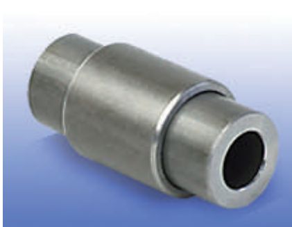
インナーパイプ(パイプ圧入品) 2種類のパイプを使用し圧入、両端の外形寸法と中心部外形寸法に変化を持たせた製品です。
